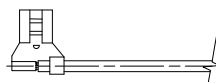
6,3x0,8 o 4,8x0,8 Faston femmina a bandiera 6.3x0.8 or 4.8x0.8 Female flag rolled receptacle
