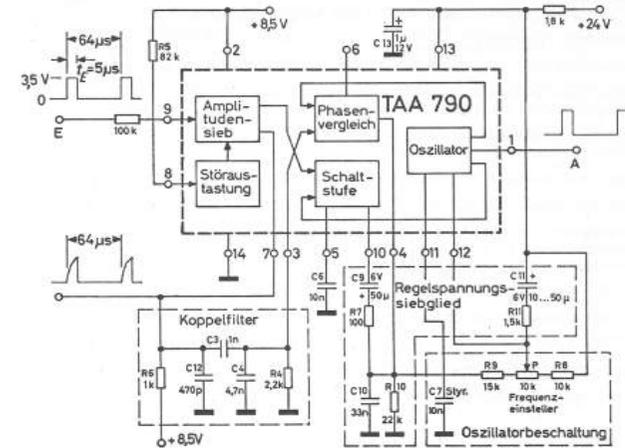
Bild 3: Meßschaltung für die Kennwerte des TAA 790. Externe Schaltungselemente Toleranz  $\pm 1\%$ .
