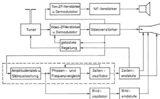
Bild 1: Blockschaltbild eines Fernsehempfängers.
